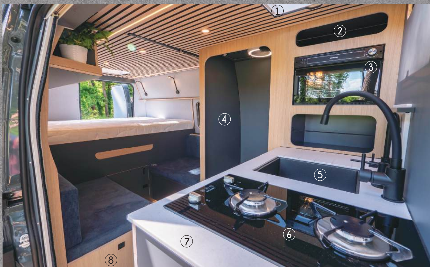
1. Lanterneau Dometic 70x50 - 2. Rangements - 3. Four intégré - 4. Douche avec porte ROLdoor 5. Évier sous plan avec capot - 6. Plaque de cuisson - 7. Plan de travail Corian® 8. Tiroir sous banquette
